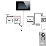
Anschluss einer Lampe (z.B. Treppenhandslicht) über Modul DT-RLC
